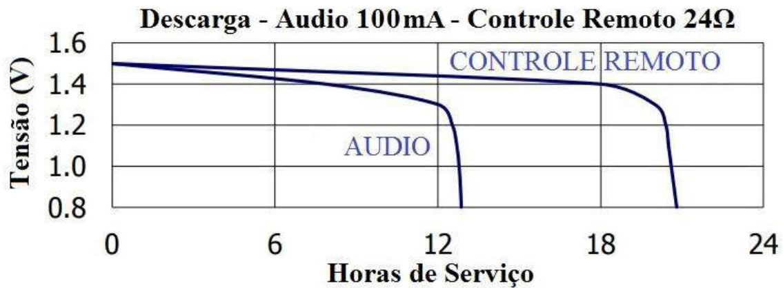
Figura 85 – Tensão x horas de serviço com 100 mA e 24Ω para baterias LiFeS 2 – tamanho AAA
