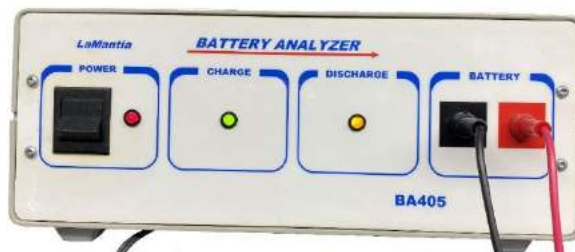
Figura 197 – Analisador de baterias
