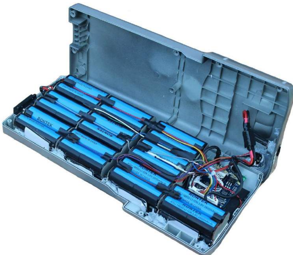
Figura 140 – Pack de baterias com 40 células de lítio íon para e-bike
