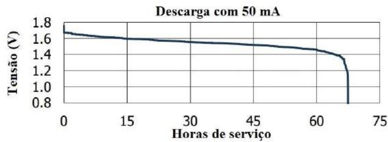
Figura 77 – Curva de tensão x horas de serviço com 50 mA para baterias LiFeS 2 – tamanho AA
