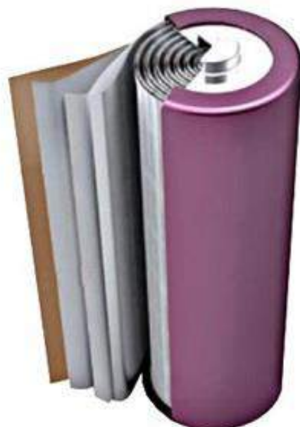
Figura 109 – Formato construtivo da bateria de lítio ferro
